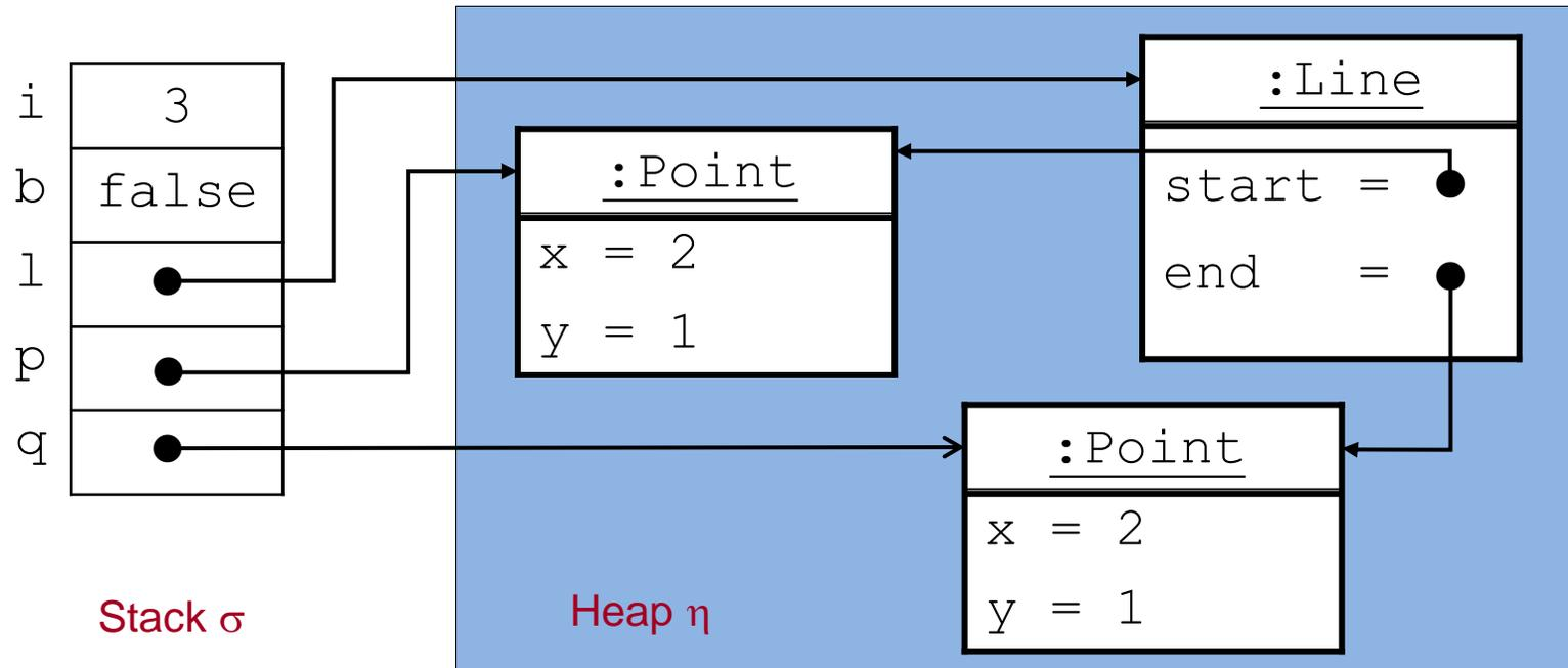
$(p==q)_{(\sigma,\eta)}$  false,  $(p!=q)_{(\sigma,\eta)}$  true,  $(q==l.end)_{(\sigma,\eta)}$  true
