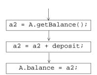
Jeder Bankangestellte geht zum Kontobuch, sieht den Wert nach und geht dann später wieder hin, um den neuen Wert einzutragen. Damit ist der erste Eintrag verloren.  $\Rightarrow$  "Race Condition", Interferenz zwischen Threads
