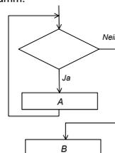
Das Kontrollflußdiagramm besitzt die unterschiedlichen Abläufe B und AB, AAB,...
