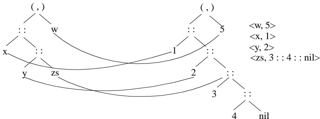
Um ein Pattern mit einem Ausdruck zu vergleichen, überlagern wir die beiden Bäume und vergleichen zunächst die Wurzeln und dann induktiv die Teilbäume. Dabei werden Bindungen für die Variablen des Pattern aufgebaut. Beim Vergleich unterscheidet man die folgenden Fälle:
