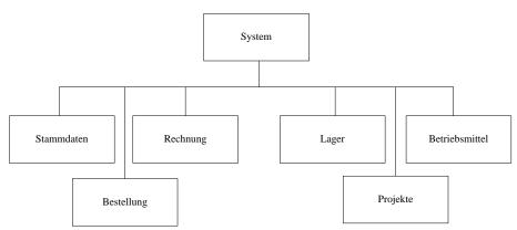
b) Entwerfen Sie die work breakdown structure. Gehen Sie dabei nach Produktstruktur und Entwicklungsprozess vor.
