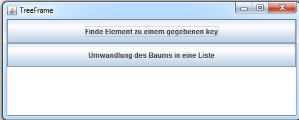
Es soll zwei Buttons, einen für die Suche eines Elements zu einem gegebenen Schlüssel und einen zum Umwandeln des Baums in eine Liste, geben. Darunter soll ein Ausgabebereich platziert werden, in dem Rückmeldung über die Ergebnisse gegeben wird.
